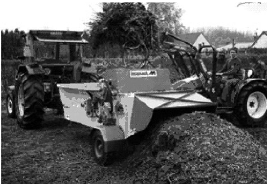
El triturador ha sido especialmente concebido y diseñado para la trituración y la desfibración de desechos verdes destinados a la fabricación de compost.
