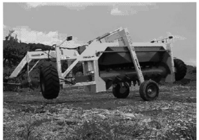
Equipado de un rotor de 4m de largo y utilizando la potencia motriz de un tractor de 100 hp, este volteador automotor puede trabajar sobre un ancho de 4.30 m y una altura de 1.80 m.
