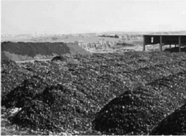
Con 4.5 m de base, 1.8 m de alto y 1.5 m en la cima, cada metro lineal del andén puede albergar 4m<sup>3</sup> de materia orgánica. Para la obtención de un compost de calidad es imperativo voltear la materia que fermenta, homogeneizarla, airear la masa en curso de compostaje. Esta actividad la facilita el volteador de andenes.
