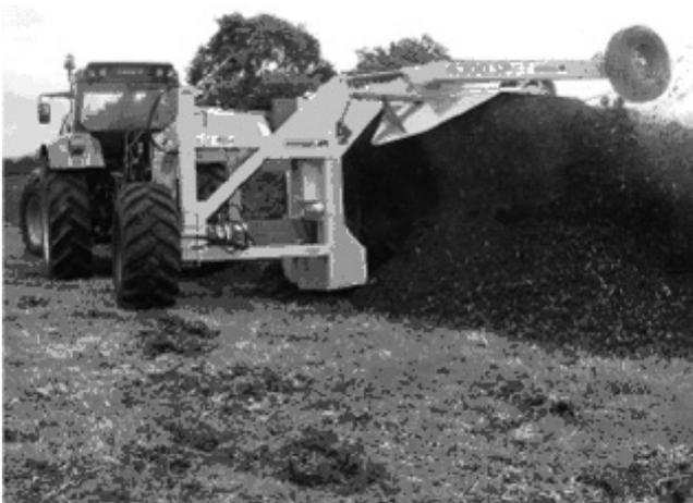
El diseño de esta máquina ha sido realizado para levantar la materia en curso de compostaje, mezclarla, airearla y volver a formar un andén homogéneo de dimensiones óptimas después de su paso. Así las materias se mezclan de manera homogénea y se obtiene un producto de alta calidad y rendimiento.
